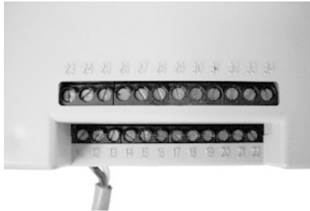
Figura 3: Morsetti di controllo del controllore SMC-Flex
