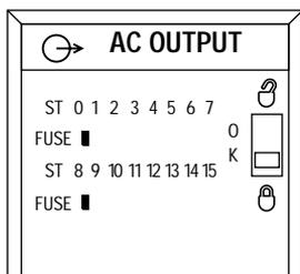
Durante el encendido, se realiza una prueba del indicador. El indicador "OK" se ilumina en el color rojo durante 1 segundo y luego parpadea de color verde si ha pasado la auto prueba. Los indicadores de E/S estarán iluminados durante un máximo de 2 segundos.
