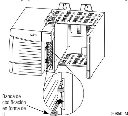
2. Codifique el RTB en posiciones que correspondan a posiciones del módulo no codificadas. Inserte primero la parte redonda de la lengüeta en forma de cuña en el RTB. Empuje la lengüeta en el RTB hasta que se detenga.
