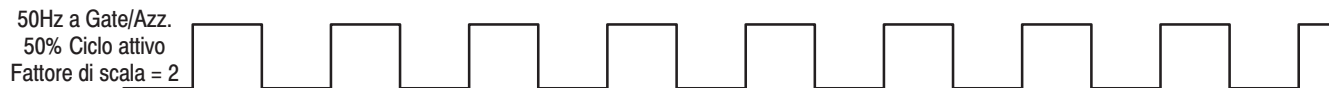
Figura E.2 Funzionamento delle uscite in periodo/frequenza e Continuo/Frequenza con fattore di scala = 2
