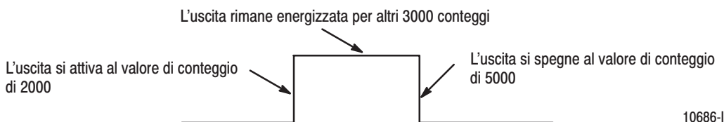
Figura 1.11 Funzionamento On-Off dell'uscita
