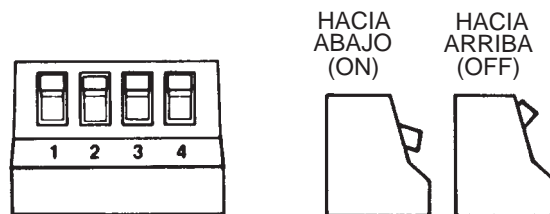
Figura 3.7 Conjunto de interruptores SW-4
