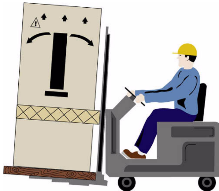
图 1 使用叉车移动马达控制中心
