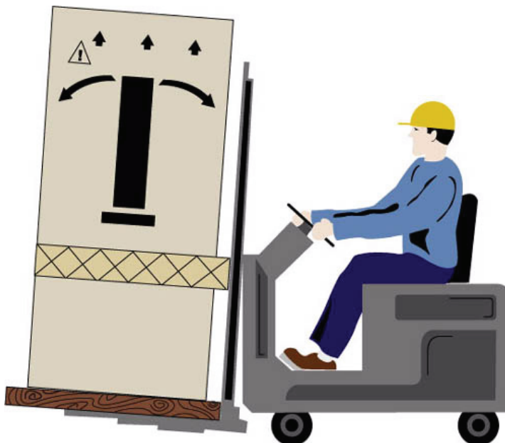
Рис. 1 Использование вилочного погрузчика для перемещения центра управления электродвигателями
